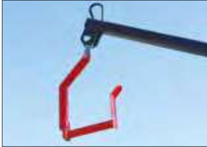
Crochet spécial fermettes rotatif homologué.
