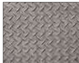
Plancher métal antidérapant.
