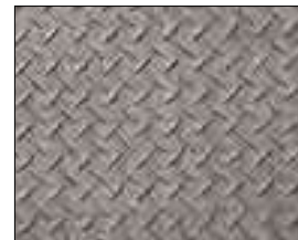
Plancher métal antidérapant.
