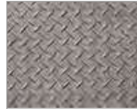
Plancher métal antidérapant.
